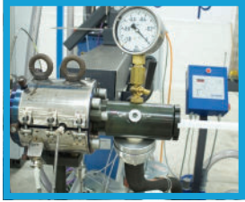
2° ESTRUSORE (colla) con controllo gravimetrico
