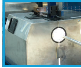
SALDATRICE saldatura alluminio, controllo parametrie controllo visivo della stessa mediante telecamera
