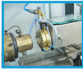
1° ESTRUSORE con controllo gravitermico (formazione tubo interno)
