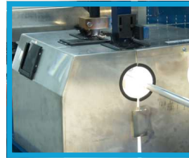
SOUDEUSE soudage de l'aluminium, contrôle des paramètres, inspection visuelle par caméra
