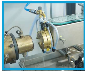
1RE EXTRUDEUSE AVEC CONTRÔLE GRAVIMÉTRIQUE (FORMATION DU TUBE INTERNE)
