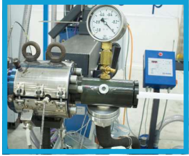
2E EXTRUDEUSE (COLLE) AVEC CONTRÔLE GRAVIMÉTRIQUE
